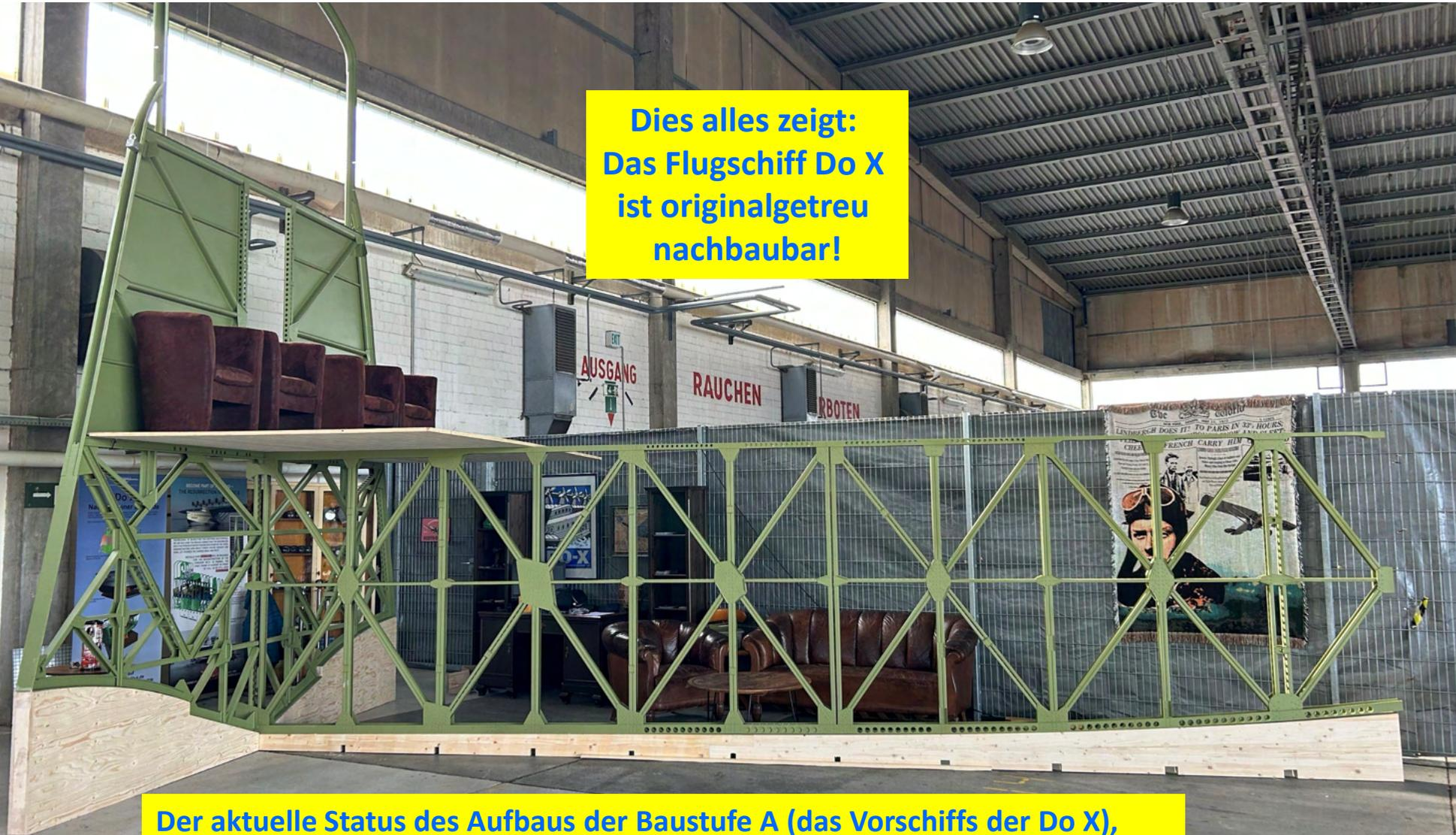
Der aktuelle Status des Aufbaus der Baustufe A (das Vorschiff der Do X), bestehend aus Spant 44 und dem Mittellängsträger (MLT) des Vorschiffs.
