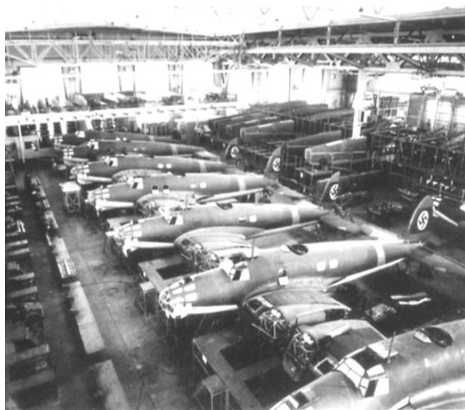
Rumpfmontage der He 111 in der Bauhalle der Dornier-Werke Wismar GmbH, 1937
